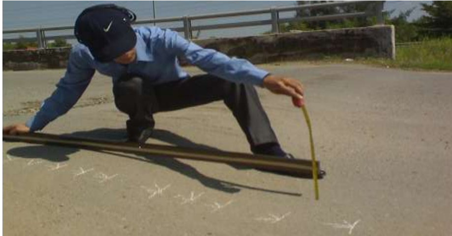
Hình 3.5. Đo dạng đường lượn cong tại điểm cuối sàn giảm tải – Cầu số 1, đường Nguyễn Hữu Thọ, Tp.HCM (12/11/2011)
