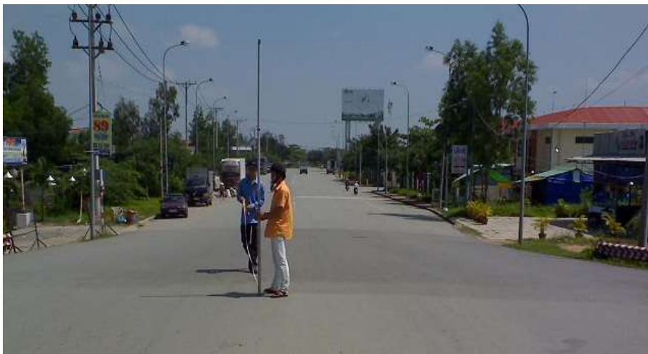
Hình 3.6. Đo dạng đường lượn cong tại điểm cuối sàn giảm tải – cầu Bà Dừa, huyện Cần Giuộc, tỉnh Long An (12/11/2011)
