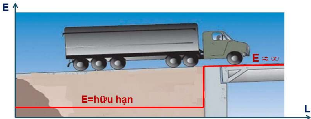
Hình 1.13. Sự thay đổi đột ngột độ cứng nền đường tại vị trí tiếp giáp
